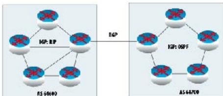
Figura 1.1. Protocolos de enrutamiento a: interior y entre sistemas autónomos
