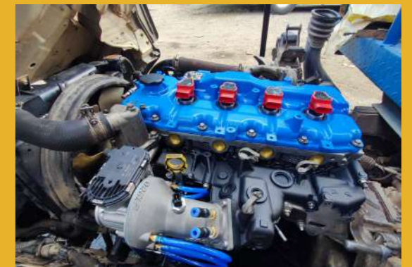
Fig. 1 Prueba de la prueba Fig. 2 Motor convertido de diésel a gas natural.
