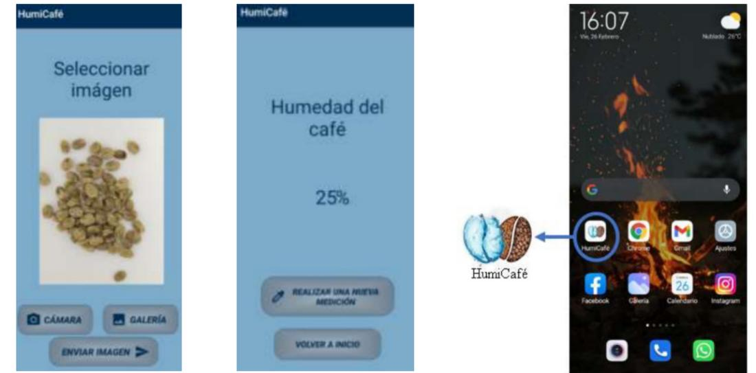
Humicafee es un sistema experto de clasificación de imágenes digitales para medir la humedad en granos de café, de bajo costo y fácil acceso, que puede ser instalado en un dispositivo móvil de gama media-baja.
